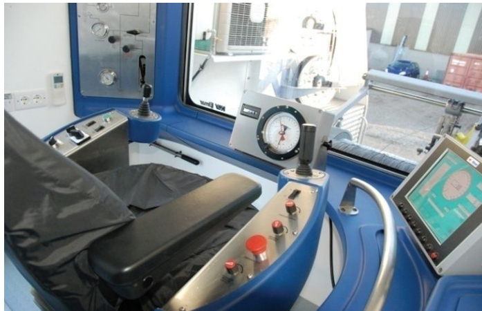
Cabine Unité Slick line
